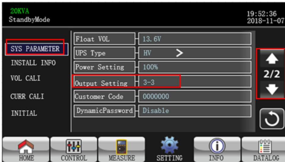
NOTA: Los ajustes de los parámetros se guardarán sólo cuando el SAI se apague normalmente con la batería conectada.
